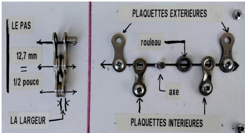
Le principe de la chaîne à rouleaux est acquis vers 1889 en Angleterre et bien installé dans la production : des plaquettes latérales qui se chevauchent, reliées par des rivets et autour de ceux-ci, un petit tube ou galet qui tourne autour de l'axe qui sert de rivet. Avec une double lubrification, interne et externe, le frottement devient très faible<sup>1</sup>(photo ci-contre).
